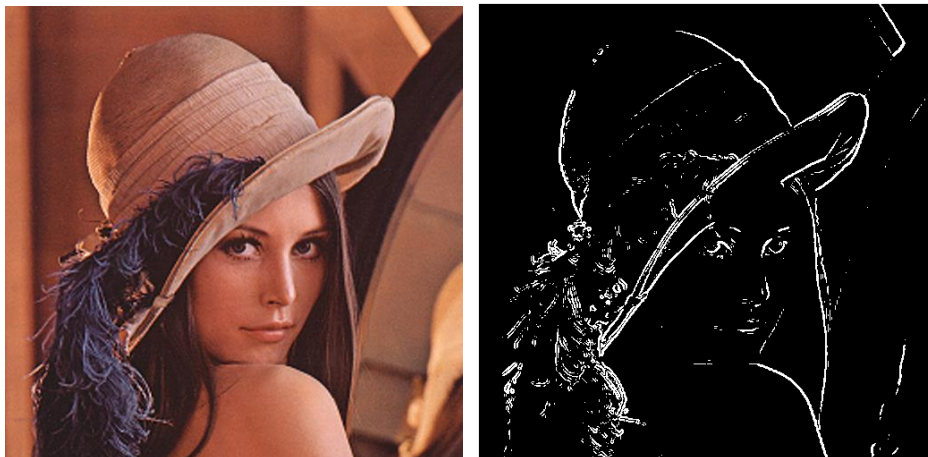
Abbildung 1: Beispiel des Sobel-Filters
