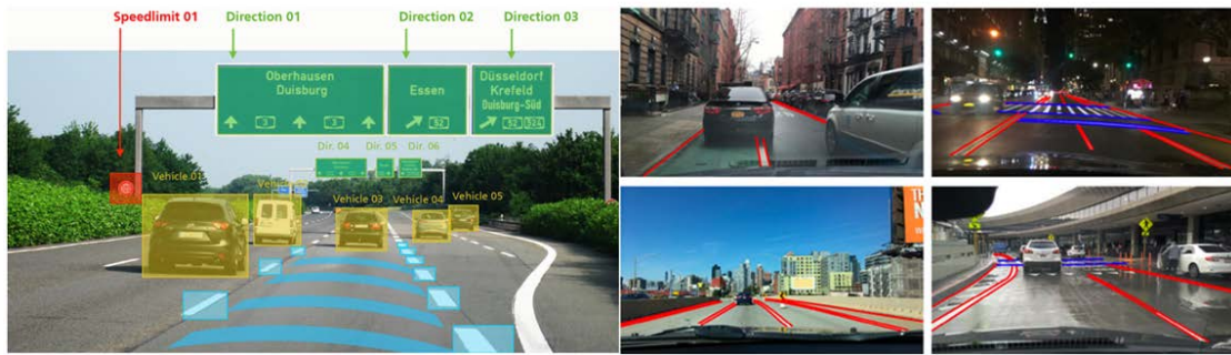
Abb 5: Verkehrsobjekt- und Fahrbahnmarkierungserkennung durch Neuronale Netze
