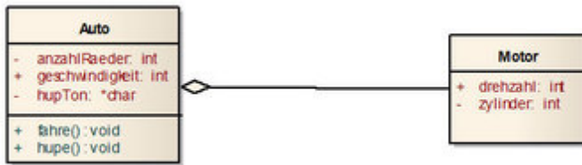
Bild 3: Die Aggregation der UML ist eine „besteht aus“-Beziehung. Das Auto besteht (unter anderem) aus einem Motor. Eine Aggregation kann in C realisiert werden, indem das einzubettende Objekt als Member in die Struktur des äußeren Objektes aufgenommen wird.
