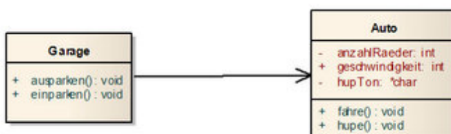
Bild 2: UML-Diagramm einer gerichteten Assoziation. Das Objekt namens Garage steht in Beziehung zum Objekt Auto. Solche Beziehungen werden in C durch Zeiger umgesetzt.
